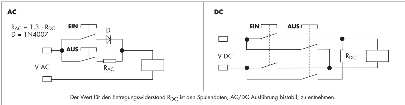
Bei Betätigung des EIN-Schalters erfolgt über die Diode eine Magnetisierung des Relais. Das Relais geht in die Arbeitsstellung und verbleibt in dieser Stellung auch nach Abschalten der Erregung.
