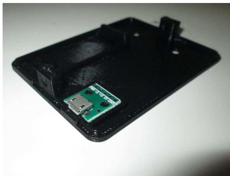
Der Anschluss für die Versorgungsspannung kann vorher oder auch nachher angelötet werden
