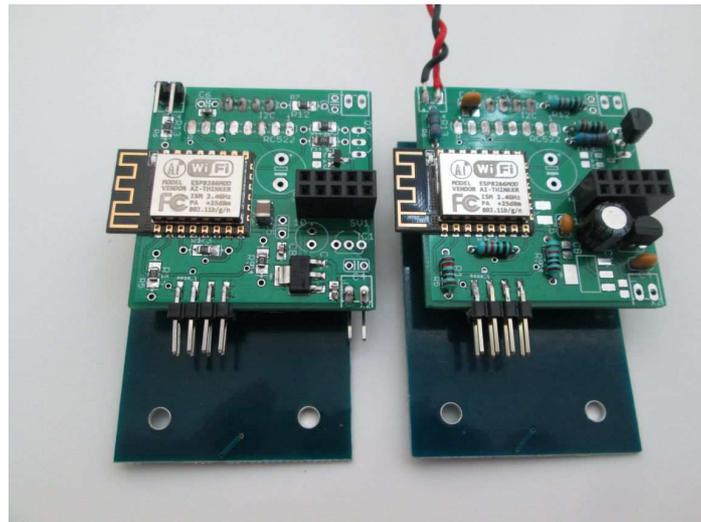
**ACHTUNG:** C3 (THD) bzw. C10 (SMD) sollte nicht verbaut werden, wenn das LAN Modul genutzt wird. Dieser Kondensator wird ausschließlich gebraucht wenn der Eingang X3 verwendet wird. Das Bestücken erfolgt nach bekannte Regeln.
