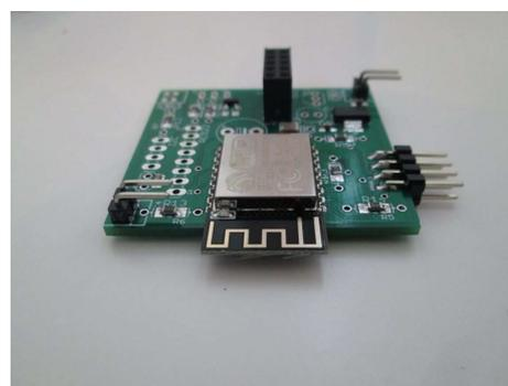
**ACHTUNG:** einige Kontakte des ESP-12 Moduls lassen sich etwas schwer löten, da diese mit GND der Platine verbunden sind. Hier zieht die Platine soviel Wärme weg, dass die Lötverbindung nicht zustand kommt.
