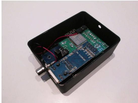
Unterseite montieren. Das LAN-Modul wird hier vom Boden eingefasst. Daher kann es sein, dass man das Modul etwas hin und her Ruckeln muss damit es genau passt. Unterseite mit zwei Schrauben sichern.
